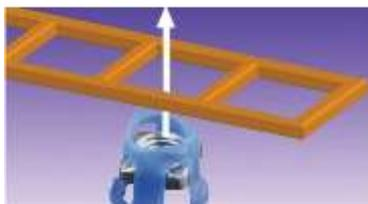
Insérez l'écrou cage par la face avant dans la découpe du profilé.
